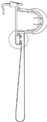
6.) Schutzfolie vom Klebepad entfernen
