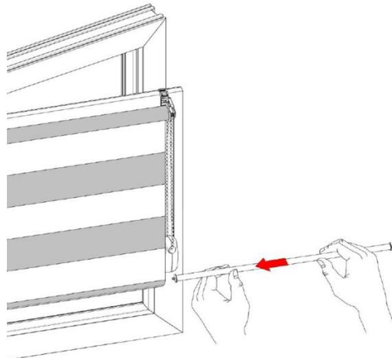
11.) Pendelsicherung in Öse der Beschwerungsstange einführen
