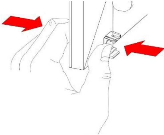
14.) Pendelsicherung mit Spannhalter einsetzen
